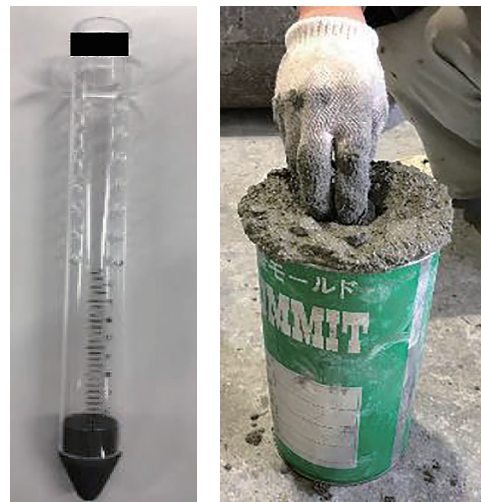
写真一 円筒貫入試験状況
