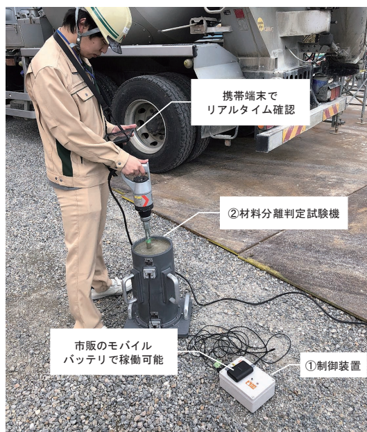
写真-3 現場での試験風景
