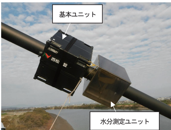
写真-11 水分測定ユニットの牽引状況
