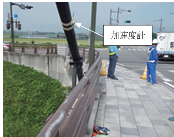
写真-8 従来の加速度計取り付け状況
