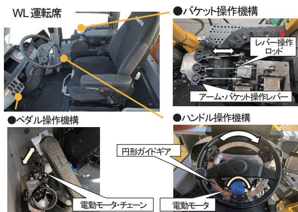
写真一 遠隔運転制御装置
