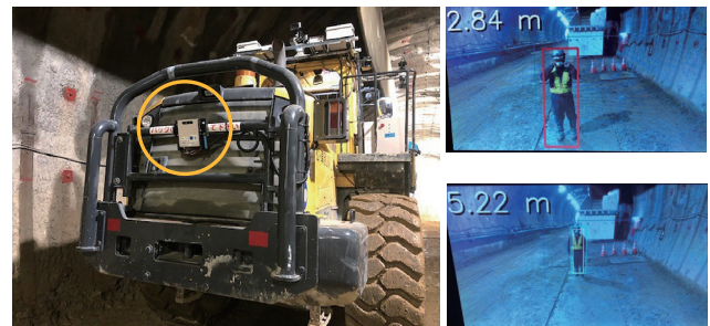
写真－5 安全走行システム設置状況
