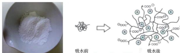
図-1 GEOSAPの外観と吸水の概念図
