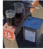
写真一-1 VSP 後添加による流動化コンクリートの製造
