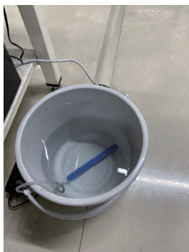
写真-2 エアレーション装置(散気管)
