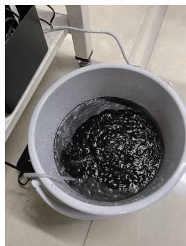
写真-3 廃脱硝材+H 2 O 2 添加+エアレーション処理状況
