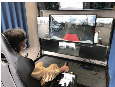
図-4 遠隔操作室からの遠隔操作状況
