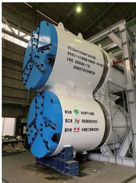
写真一 縦二連分岐型 H&V シールド機
