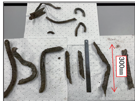
写真三 切削された鉄筋
