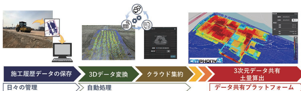
図一 ICT 土工管理システムの概要
