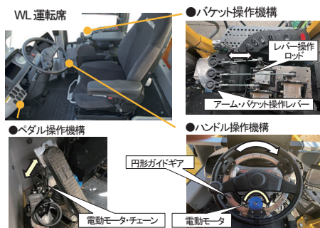
図二 遠隔運転制御装置
