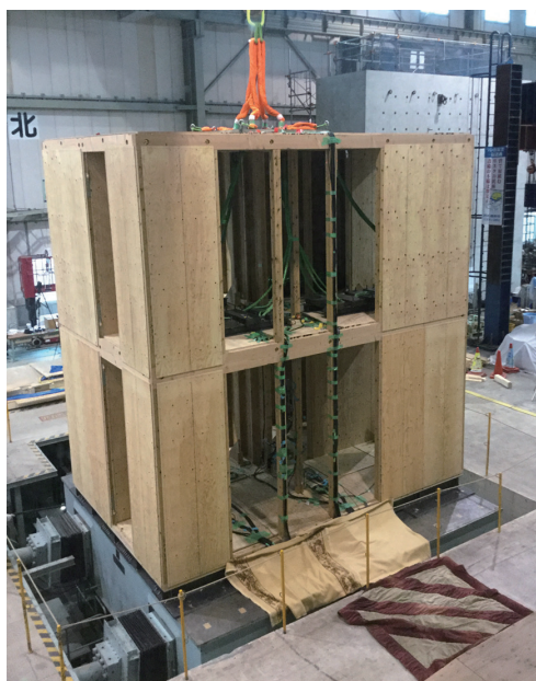
写真-1 木造制振建築物実大試験体
