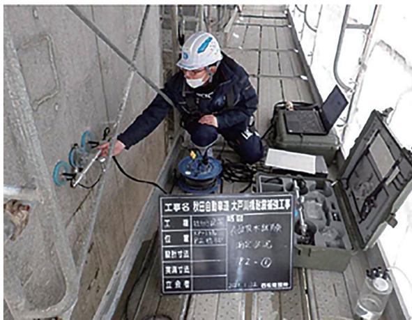
写真-10 表面吸水試験 (SWAT)
