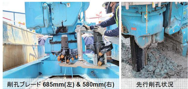
削孔ブレード 685mm(左) & 580mm(右)
