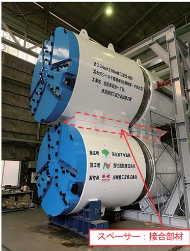
写真一 縦2連分岐型 H&V シールド機
