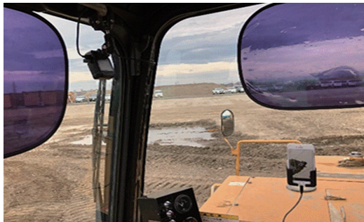
写真-5 Web カメラおよび GPS 設置状況
