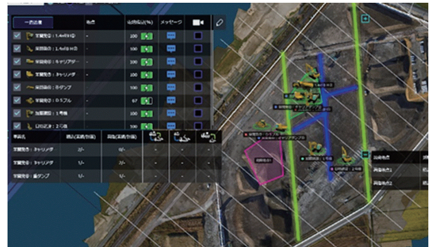
写真-8 現場事務所での GPS モニター状況
