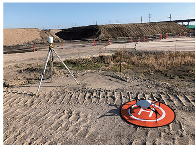
写真ー1 土量測量に使用した UAV
