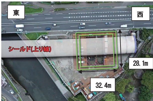
図ー4 立坑とシールドマシン通過位置 平面図
