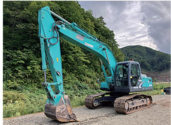
図-3 0.8 m<sup>3</sup> 級油圧ショベル (R/C 遠隔仕様)
