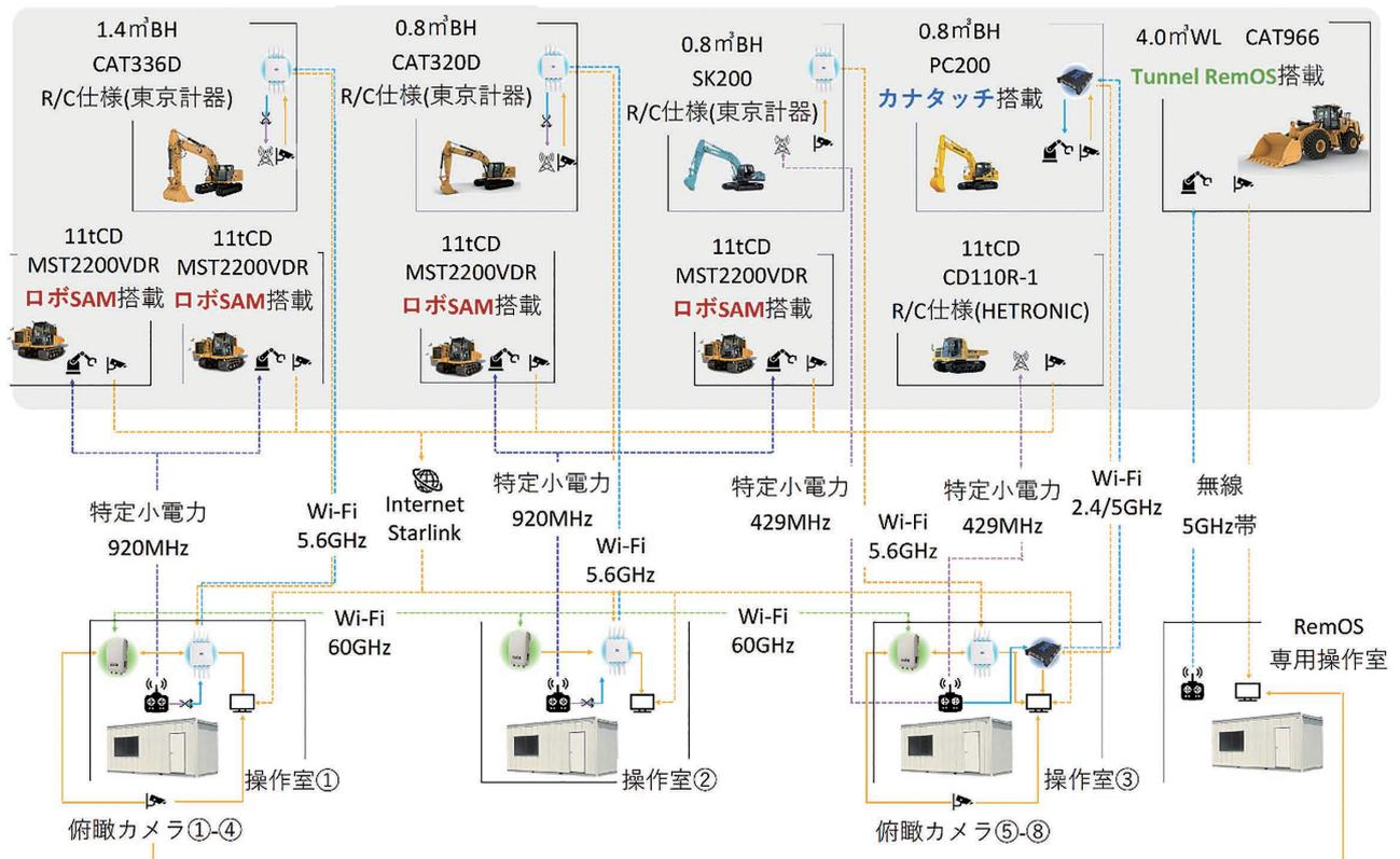
図-8 通信系統図
