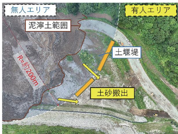
図-1 遠隔操作による施工エリア
