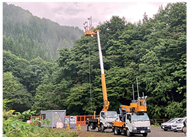
図一10 俯瞰カメラ台車（高所作業車）
