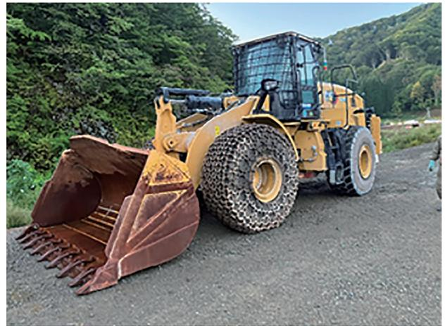
図-6 4.0 m<sup>3</sup> 級ホイールローダ (RemOS 搭載)
