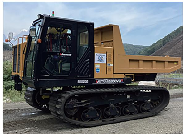
図-4 11t 級キャリアダンプ (ロボット搭載)
