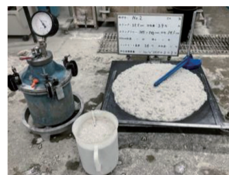
写真一1 フレッシュ性状（パースト容積率 35 vol.%）
