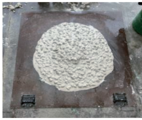
写真一五 練上がりから4時間経過後のスランブフロー
