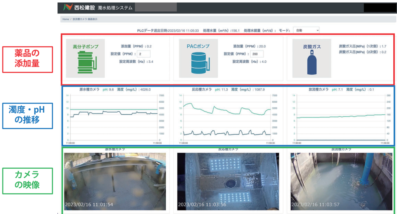
図一八 濁水処理設備遠隔監視用 Web ページ
