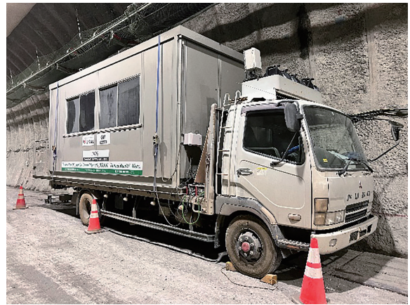
写真一1 遠隔操作室
