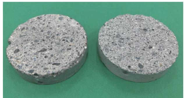
写真一3 供試体断面写真 (左 N100 右 CaR250)
