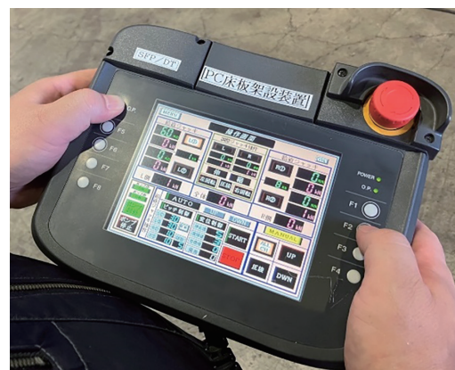
図-2 新設床版設置用装置のリモコン
