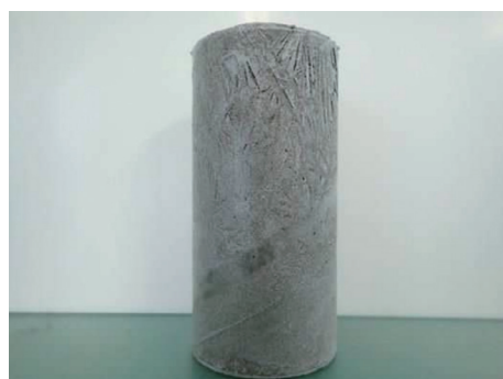
写真一3 耐寒性高性能セメントミルクを用いた試験練り供試体
