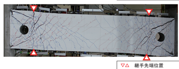
図一3 せん断力-部材角関係および破壊性状 (PB-18)
