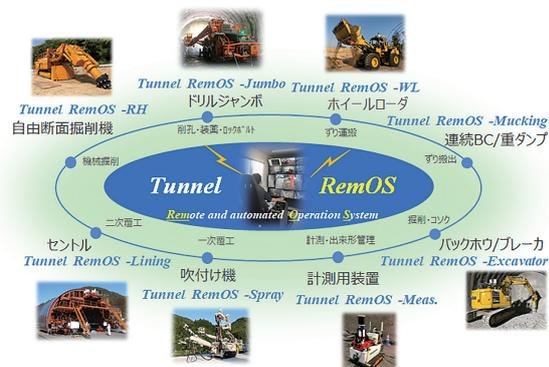
図一 「Tunnel RemOS」の概要
