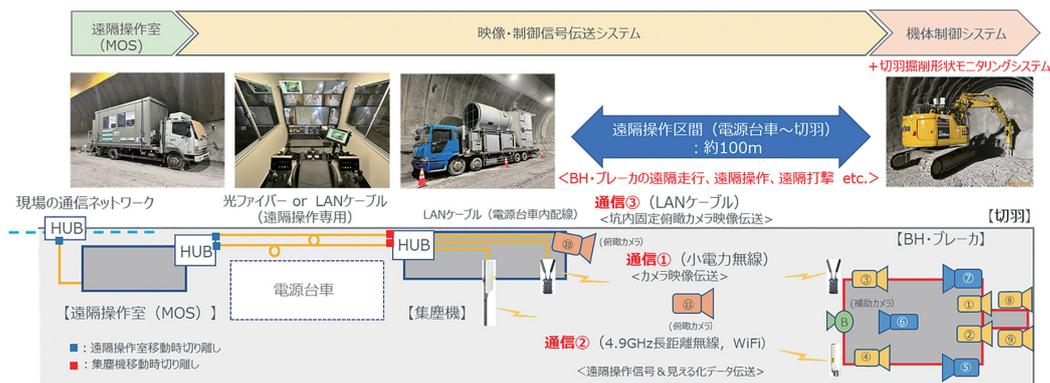
図三 油圧ショベル遠隔操作システム『Tunnel RemOS-Excavator』の構成
