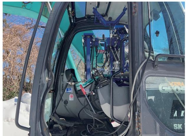
写真—11 遠隔操作装置
