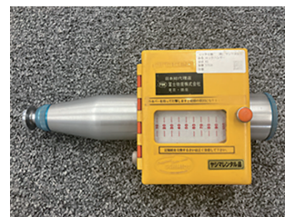
写真-5 シュミットロックハンマー試験状況
