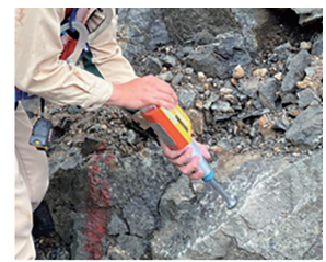
写真-5 シュミットロックハンマー試験状況
