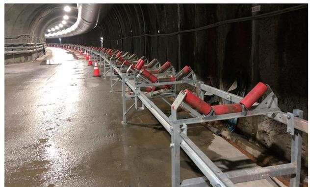
図一6 定置式横坑コンベア
