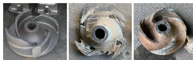
チップ加工有 加工無しの摩耗状況 加工有りの摩耗状況 図ー11 インペラ超硬合金チップ加工
