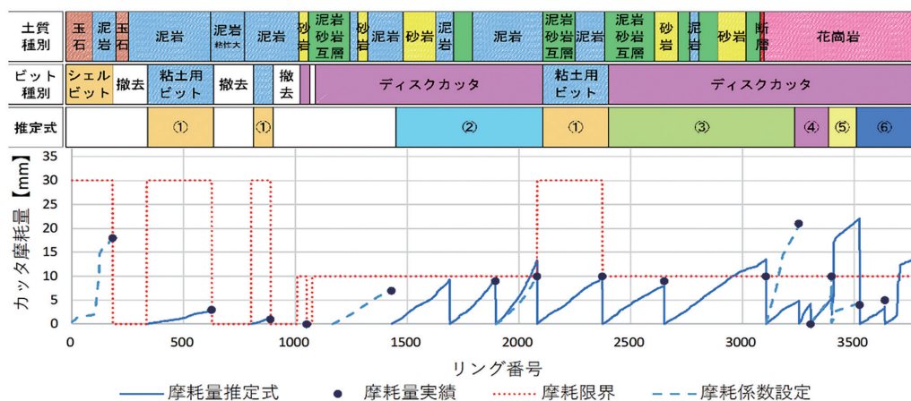
図-6 摩耗量の推定値と実測値比較 (No. 10 ビット)
