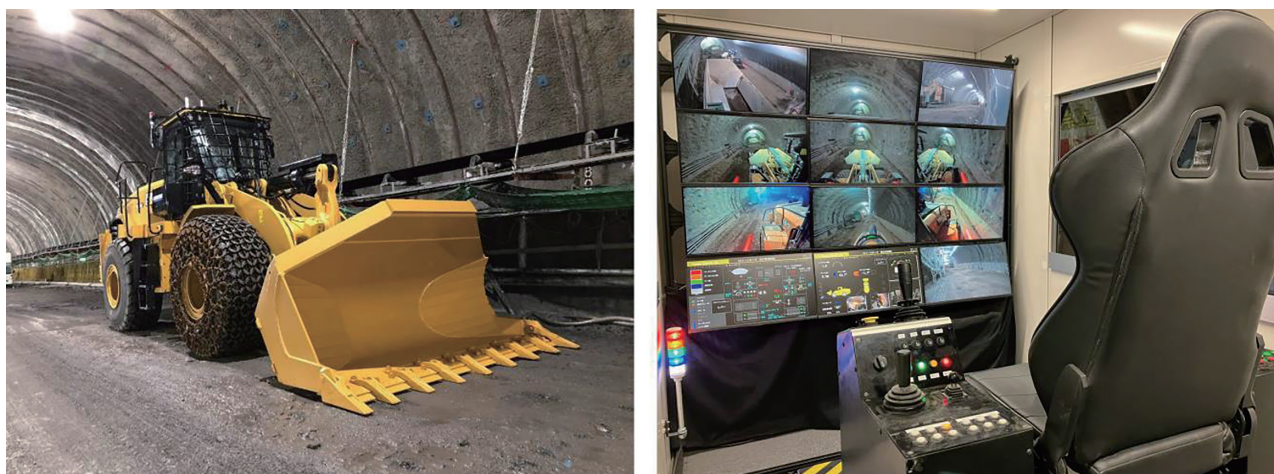
写真-3 左：遠隔仕様ホイールローダ（実用機）・右：コクピット
