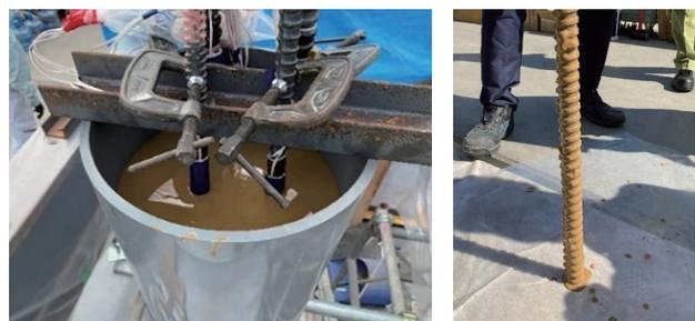
写真一1 鉄筋表面への安定液の付着状況
