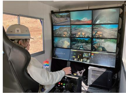
写真-2 コックピットによる遠隔操作の例
