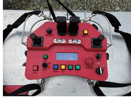
写真-1 コントローラを使用した遠隔操作の例
