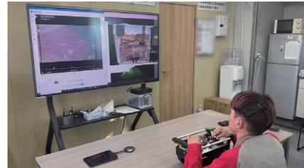
写真一3 現場事務所から長距離遠隔操縦の様子
