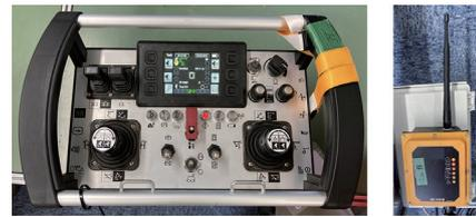
写真一4 送信機(コントローラ)および受信機
