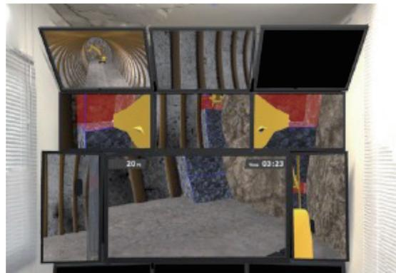
図一3 VRゴーグルで臨む模擬遠隔操作室
