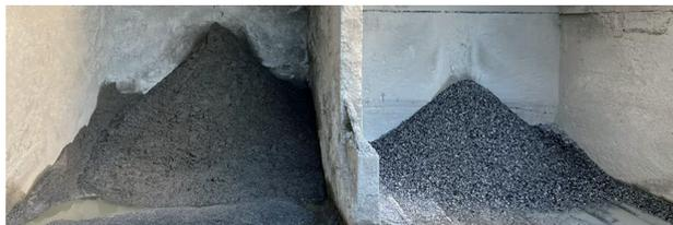
写真二 日々発生する回収骨材の集積状況
