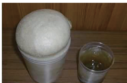
写真二 KOD-M（左：水添加1%，右：水接触無し）
