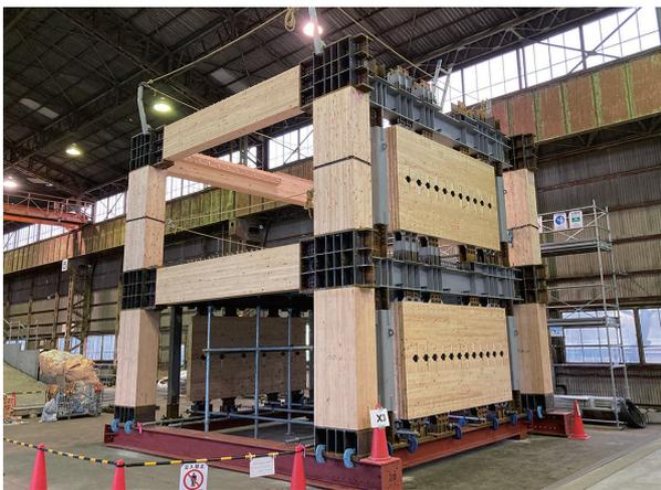
写真一 1 モックアップ試験施工の様子
