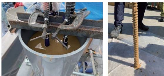
写真一1 高強度鉄筋の安定液浸漬状況
