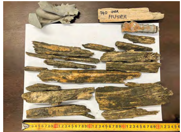
写真-3 GFRC セグメント切削片 (FFU 筋材)
