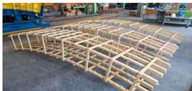
写真一1 GFRCセグメントに使用したFFU筋材
