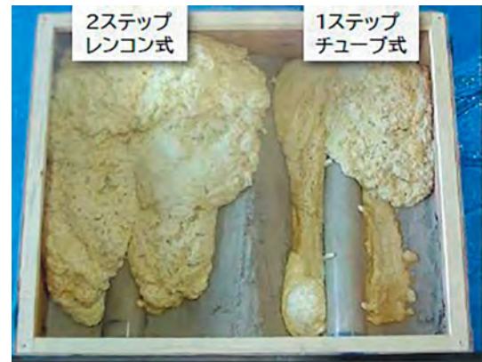
図ー6 ステップ増加による改良効果の比較
