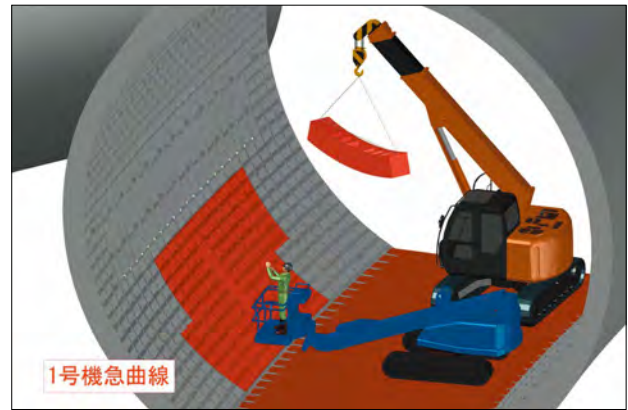
図-4 セグメント撤去施工
