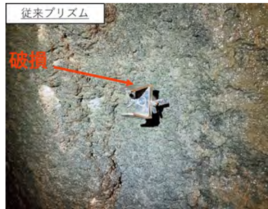
写真-6 従来プリズム破損状況
