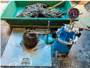
写真一1 フレッシュ試験の状況
