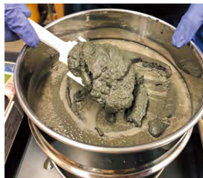
写真二 篩上に残留した一次処理土
