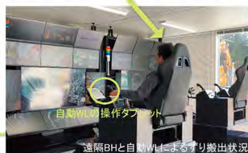
図ー11 遠隔バックホウと自動ホイールローダを使用した1名でのずり搬出イメージ
