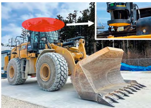
図-6 二次元LiDARを搭載したホイールローダ
