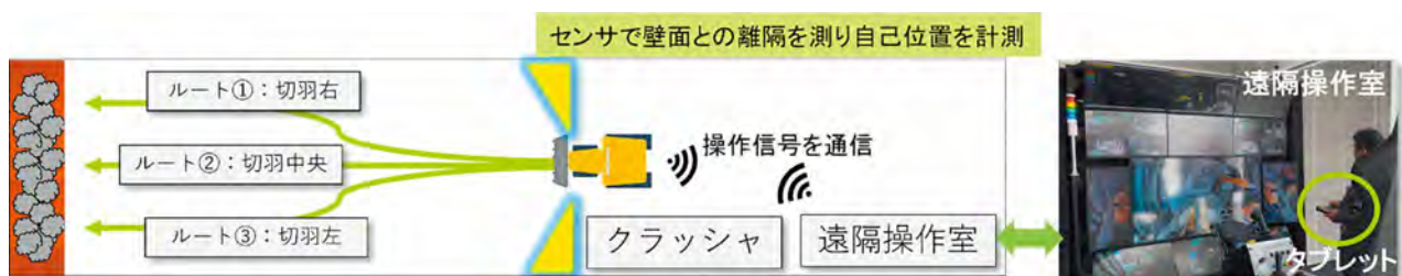
図-8 自動化したホイールローダの動作イメージ
