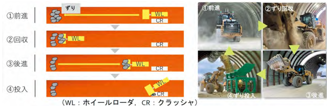
図-7 ずり搬出作業時のホイールローダの一連動作
