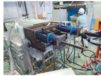
写真-1 軸力導入の状況
