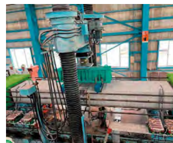
写真-3 継手曲げ試験の試験状況
