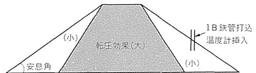
Fig-6 パイルの内部温度測定法
